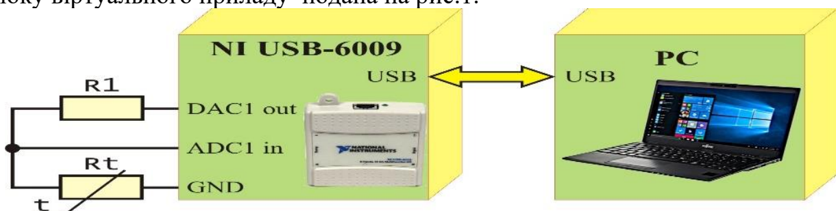
Рис. 1. Схема підключення термістора до блоку вимірювання та управління блоку NI USB-6009.
