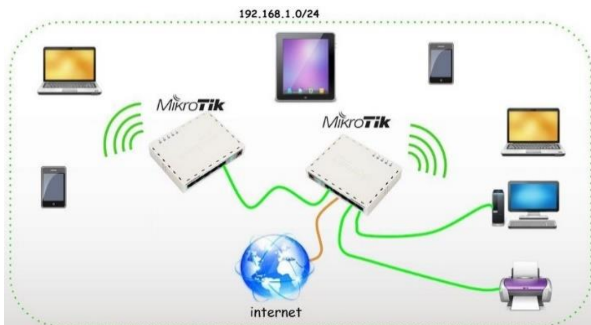
Рис. 1 Реалізація безшовного Wi-Fi без контролера на базі маршрутизаторів Mikrotik [1].
